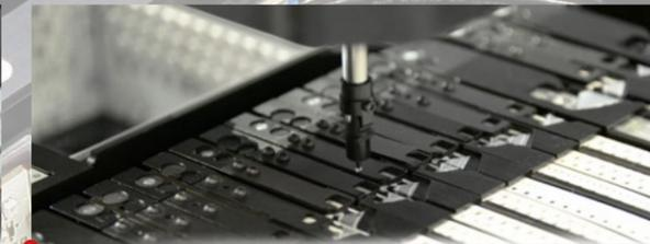
Überaus flexible intelligente Feeder, mehrspurige Kassetten oder hochpräzise einspurige Feeder. Komponenten aus Tape, Stick, Strip, Tray werden verarbeitet. Grösstes Bauteilspektrum; 01005 bis 80 x 70 mm und voll integrierte Nachverfolgbarkeit. Das intelligente Feedersystem mit Barcode Konfiguration erlaubt einen fliegenden Feederwechsel. So kombiniert und mit einer eindrucklichen Höchstzahl von 240 Feederpositionen pro Maschine ist die Paraquda ein Bestückungssystem zur idealen Wahl.
