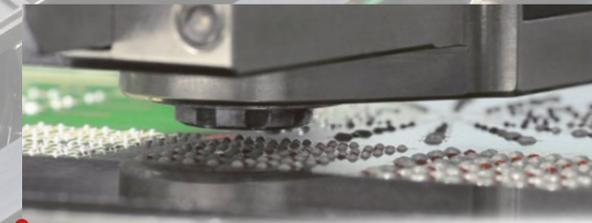
Die Paraquda kann mit einer grossen Anzahl verschiedener Dispensventile für Lotpaste, Kleber oder Damm- und Füllmedien ausgestattet werden. Prototypen bestückt man auf einfachste Weise ohne Schablone, was die Durchlaufzeit erheblich verkürzt. Das Dispensieren von zusätzlicher Lotpaste erspart die teuren gestuften Schablonen. Das System läuft mit der gleichen bewährten Software wie die Scorpion und liefert identisch professionelle und ultraschnelle Dispenslösungen.
