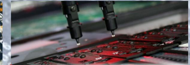
Überaus flexible intelligente Feeder, mehrspurige Kassetten oder hochpräzise einspurige Feeder. Komponenten aus Tape, Stick, Strip, Tray werden verarbeitet. Grösstes Bauteilspektrum; 01005 bis 80 x 80 mm, Bauteilhöhe bis 25 mm.
